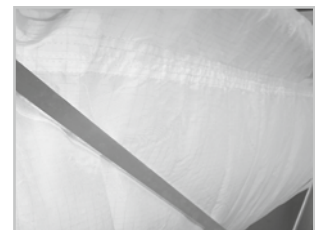
Gewebe aus einer Hightech-Faser, staubdicht, durchscheinend, dauerhaft antistatisch durch einen eingewebten Edelstahlfäden
